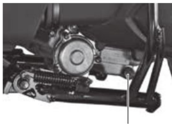
Vite di drenaggio (2)
