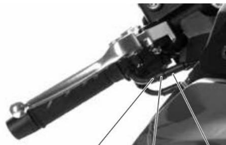
Controdado (3) Vite di regolazione (2) Manicotto in gomma (1)
